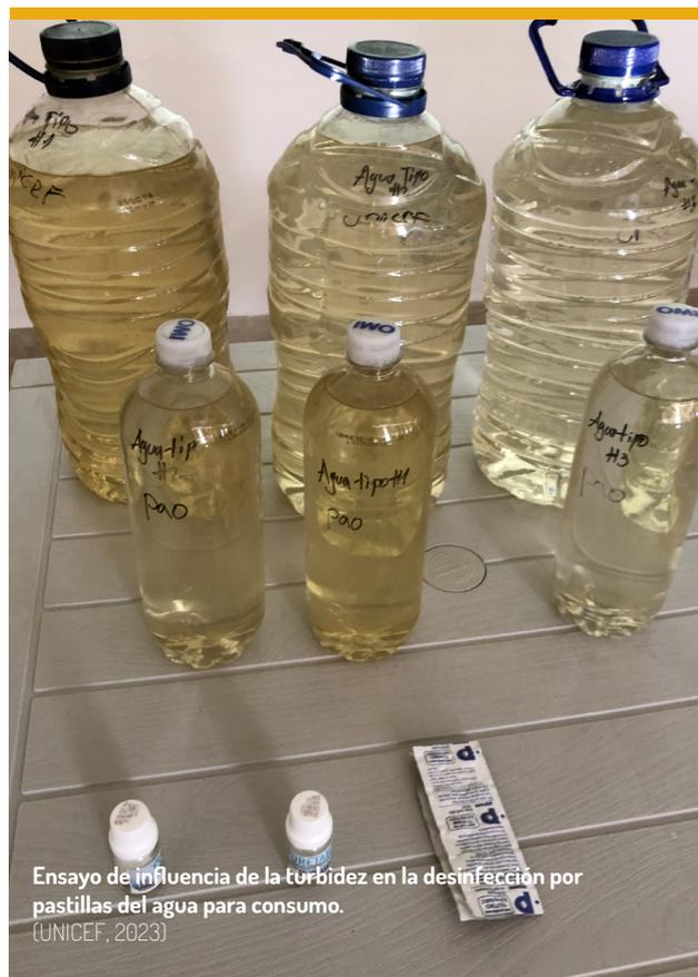
Ensayo de influencia de la turbidez en la desinfección por pastillas del agua para consumo. (UNICEF, 2023)
